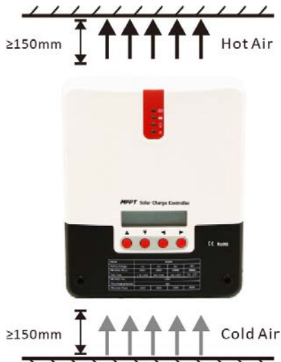
Fig 5. Instalación y disipación del calor
